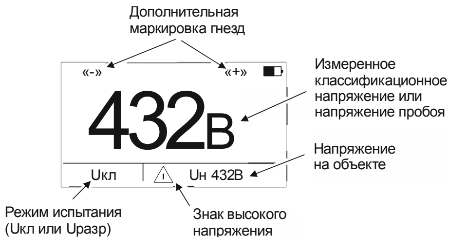
Рисунок 25 - Измерение классификационного напряжения или напряжения пробоя разрядника
