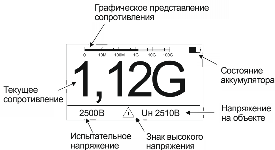
Рисунок 19 - Результат измерения сопротивления изоляции
