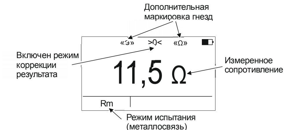
Рисунок 23 - Результат измерения сопротивления металлосвязи
