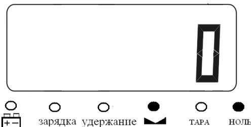
Рис.3 Индикация ненагруженных весов
