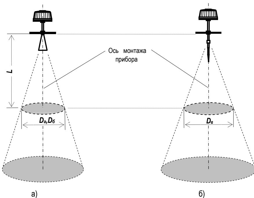
Рисунок 4 - Определение диаметра облучаемой поверхности у приборов с различными типами антенн: а) рулерная антenna ( $D_a$  и  $D_b$  – для антенн с диаметром раскрыва 145 мм и 120 мм соответственно); б) стержневая антна
