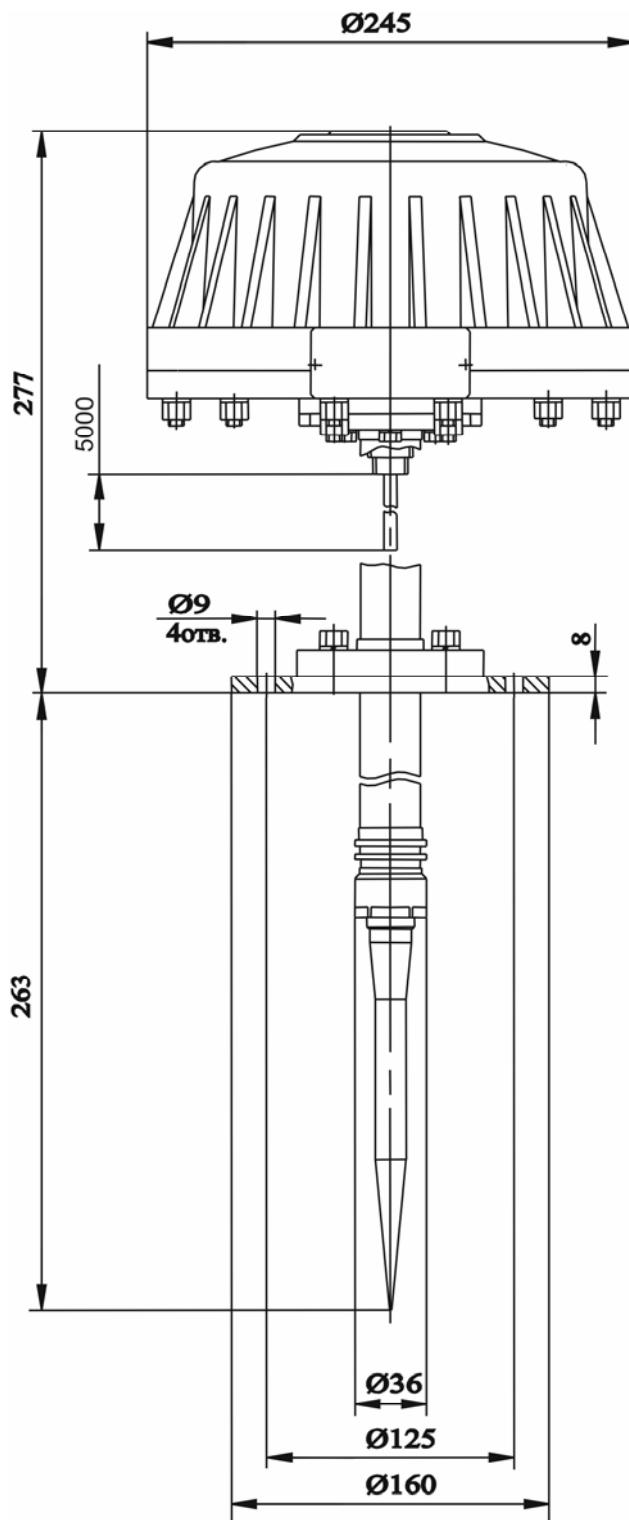
Рисунок Б.8 - Габаритные и установочные размеры прибора БАРС 351 И.14
