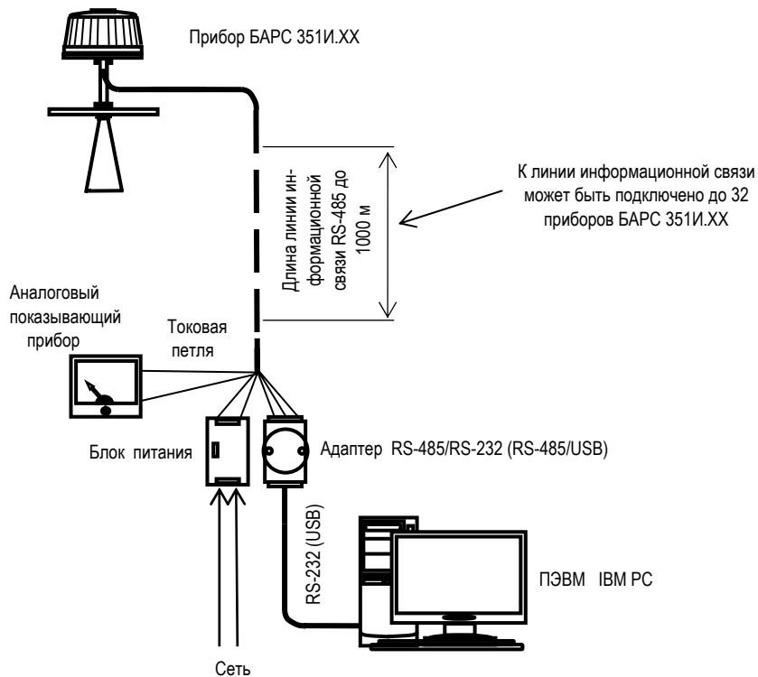
Рисунок 11 - Подключение прибора БАРС 351И.XX к внешним устройствам - ПЭВМ и аналоговому прибору
