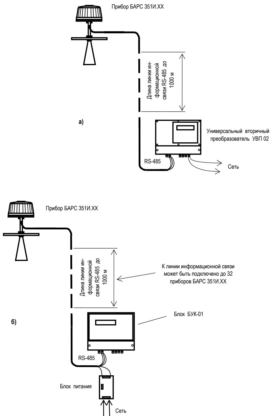
Рисунок 12 - Подключение прибора к внешним устройствам:
