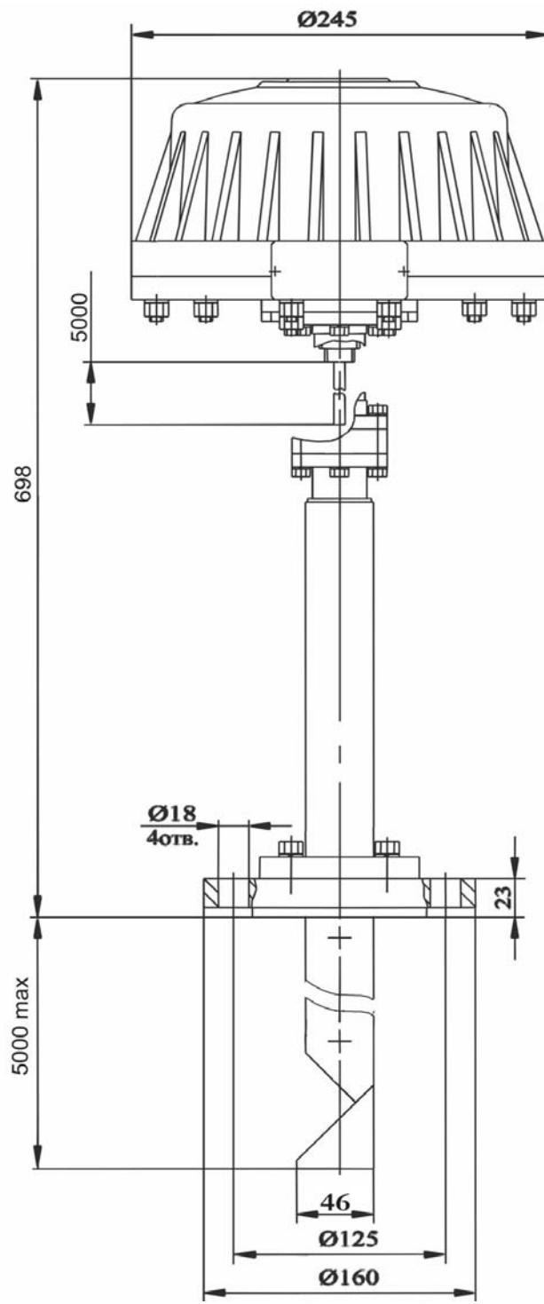
Рисунок Б.9 - Габаритные и установочные размеры прибора БАРС 351 И.16
