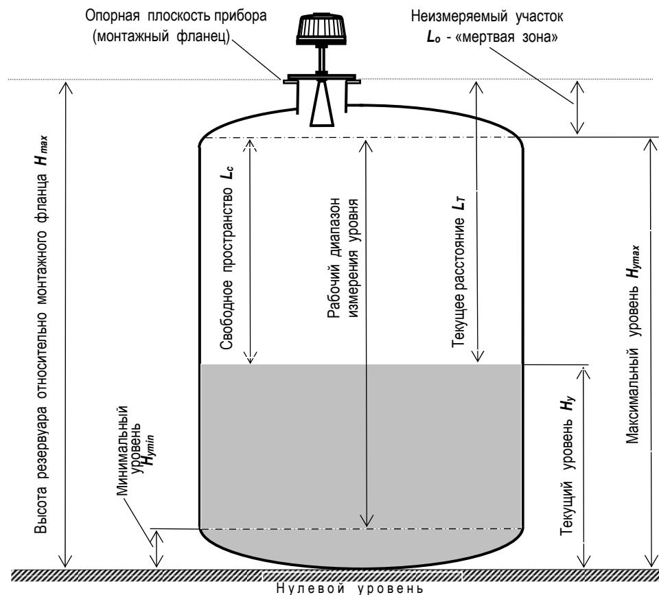
Рисунок 13 - Параметры, используемые при измерении уровня в резервуаре
