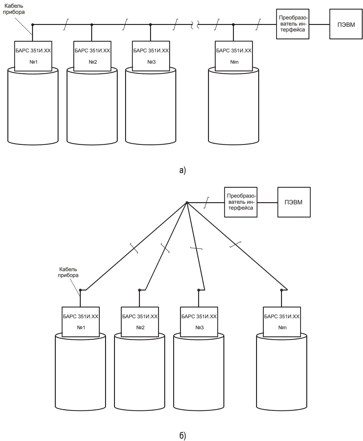
Рисунок В.3 – Реализация линий информационной связи на объекте: а) оптимальная конфигурация – линия информационной связи проложена последовательно; б) нежелательная конфигурация – линия информационной связи проложена звездообразно
