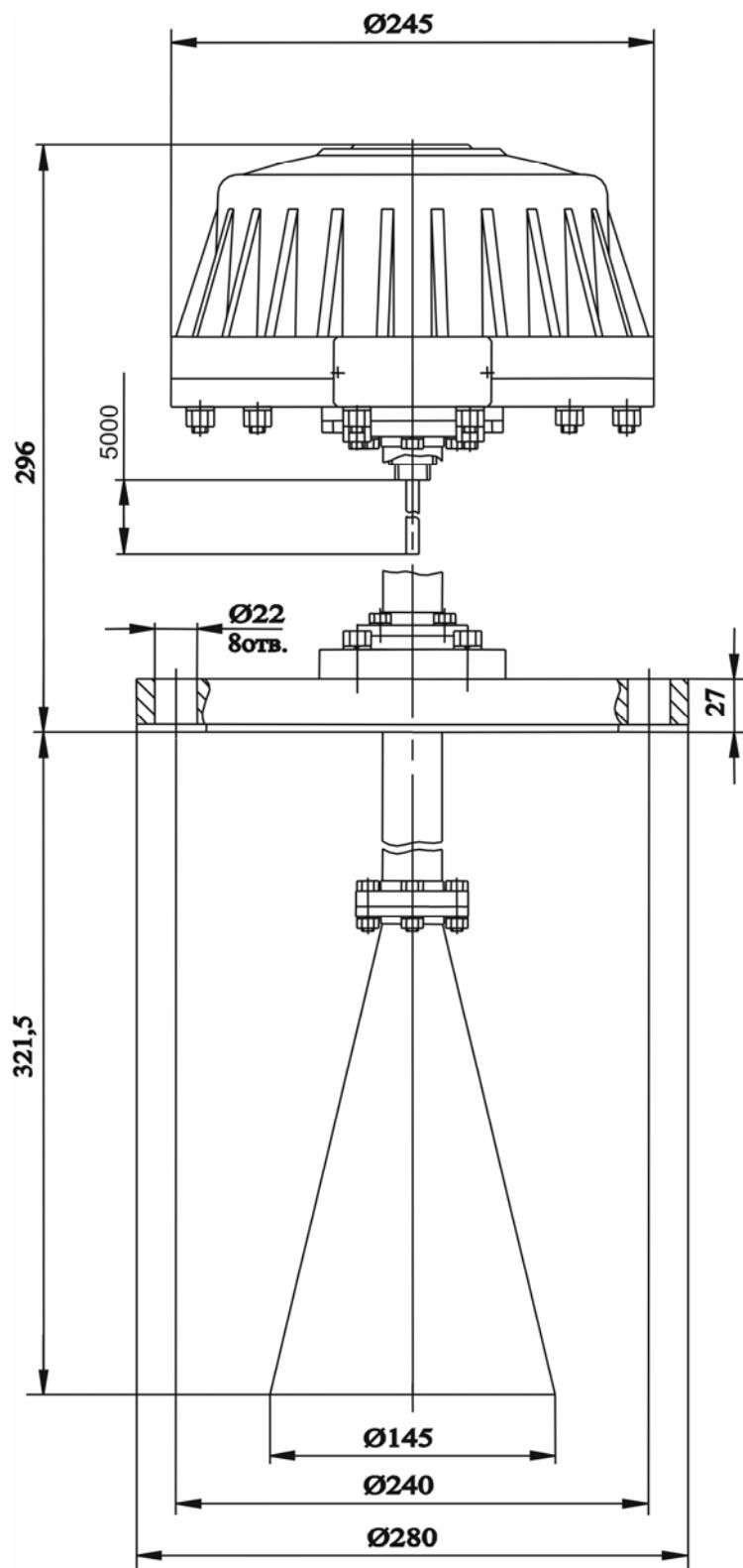
Рисунок Б.5 - Габаритные и установочные размеры прибора БАРС 351 И.08
