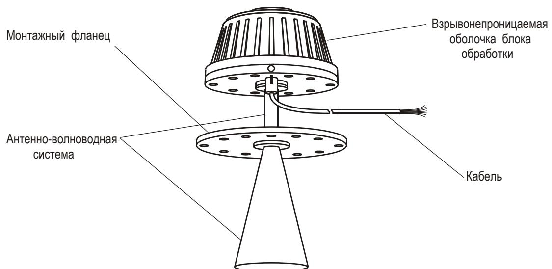
Рисунок 1 - Внешний вид прибора БАРС 351И.00
