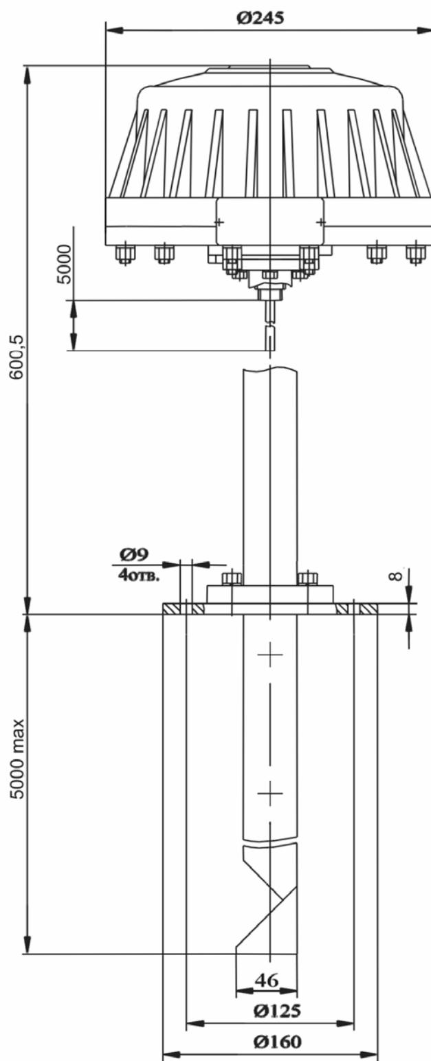
Рисунок Б.10 - Габаритные и установочные размеры прибора БАРС 351 И.18
