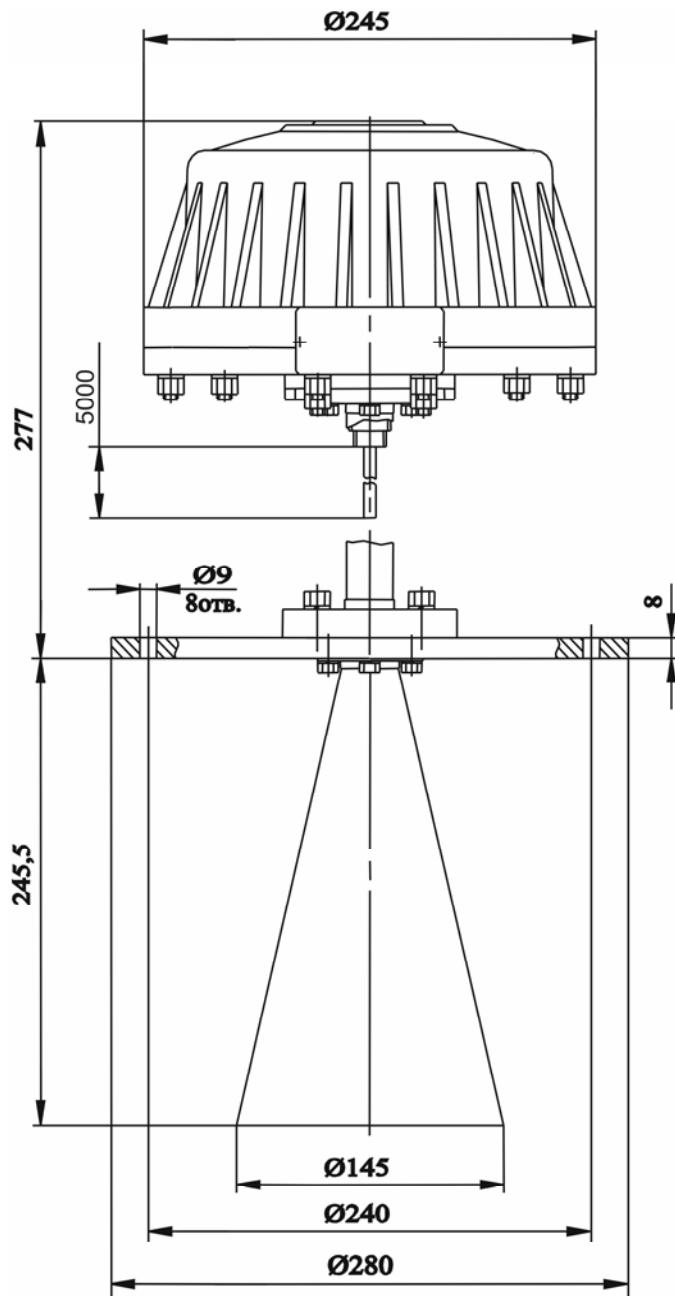
Рисунок Б.1 - Габаритные и установочные размеры прибора БАРС 351И.00
