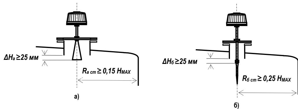
Рисунок 3 - Рекомендуемые варианты монтажа приборов с различными антеннами
