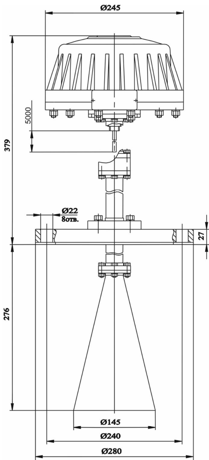
Рисунок Б.6 - Габаритные и установочные размеры прибора БАРС 351 И.10
