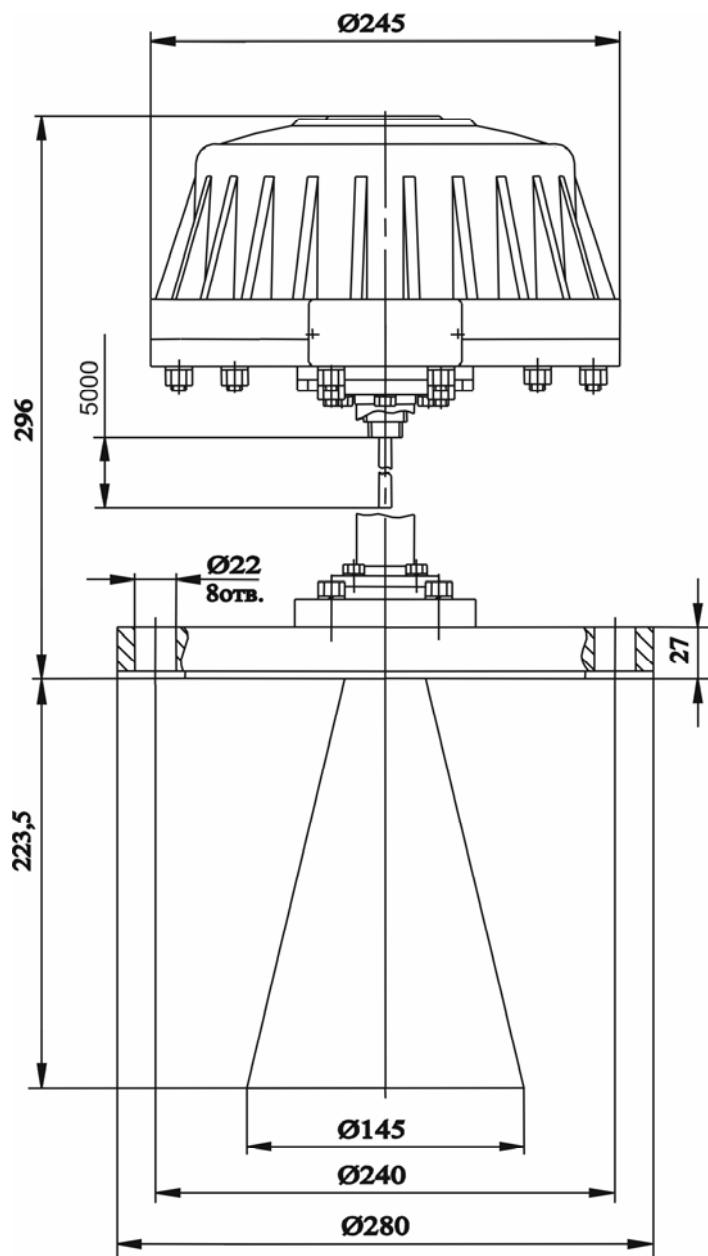
Рисунок Б.4 - Габаритные и установочные размеры прибора БАРС 351И.06
