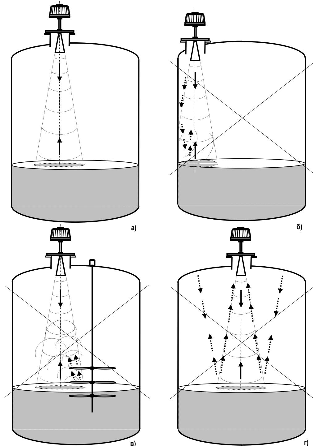
Рисунок 6 - Позиционирование прибора на рабочем резервуаре:
