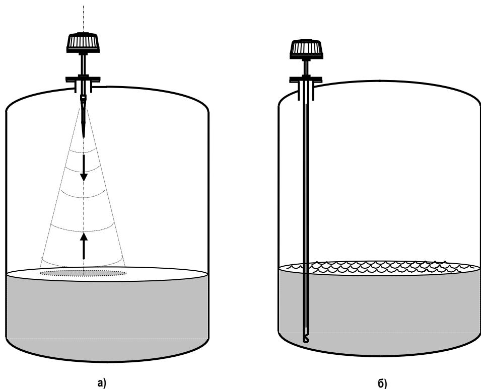
Рисунок 9 - Позиционирование прибора на резервуаре с узким патрубком:
