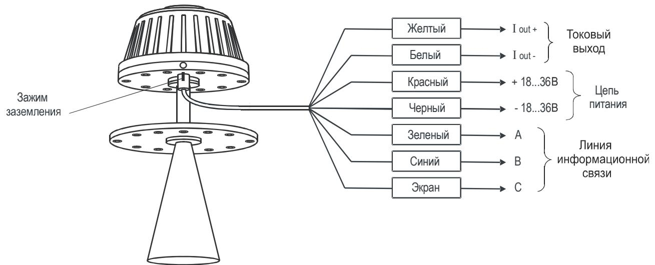
Рисунок 10 – Маркировка и назначение жил кабеля
