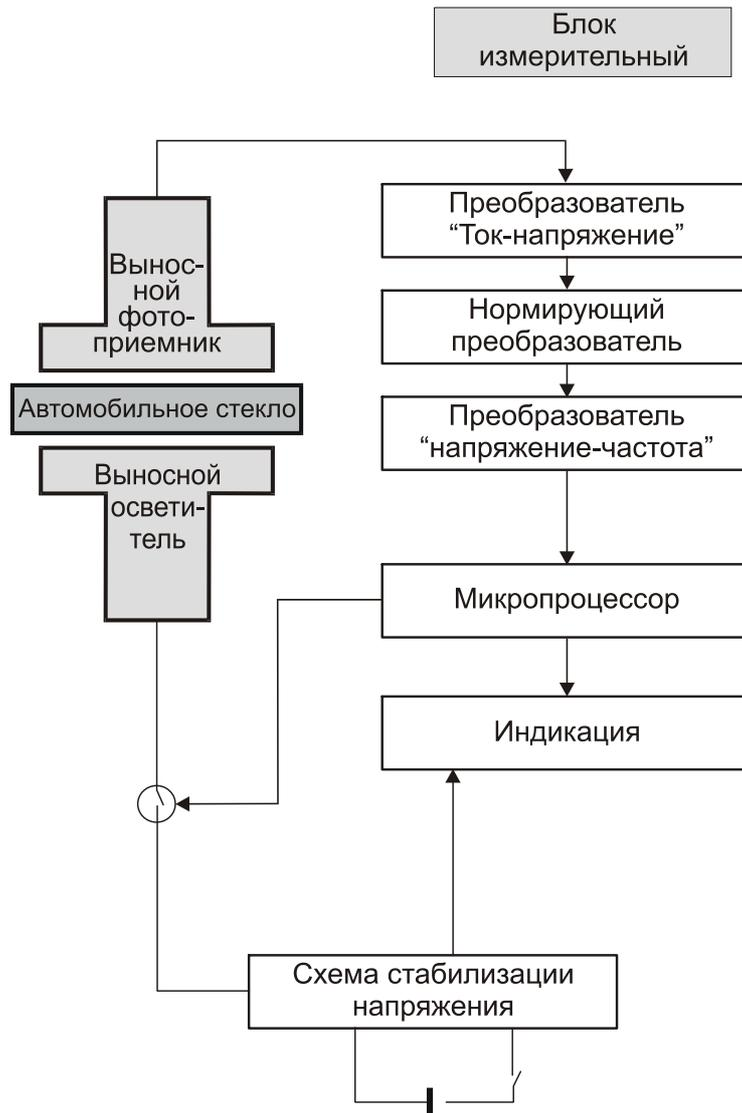
Рис. 5.1. Функциональная блок-схема измерителя ИСС-1
