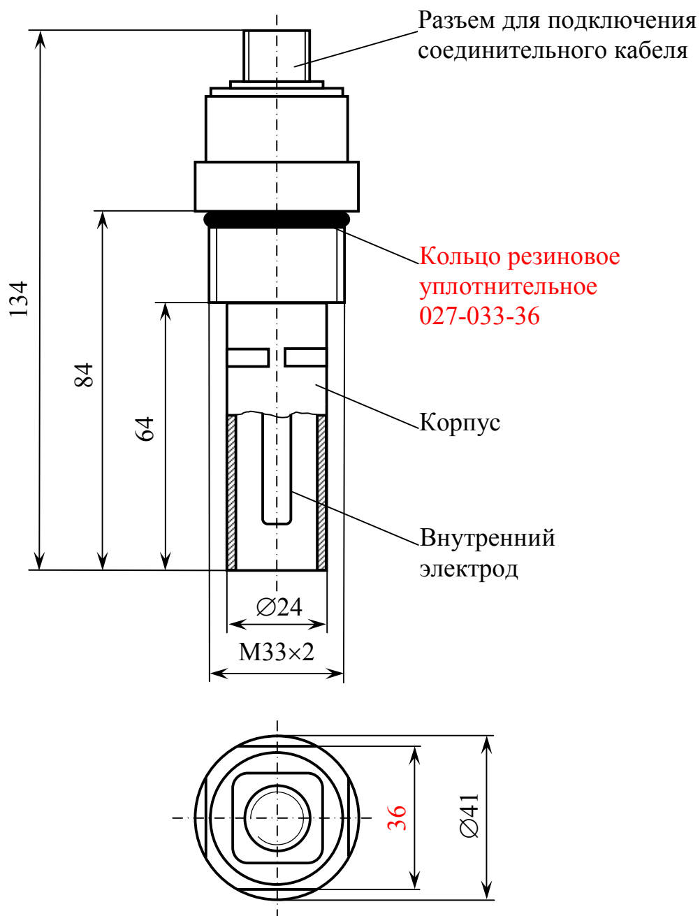
Рисунок 1.5 – Датчик проводимости ДП-003МП
