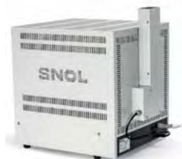
Электропечь SNOL с системой вытяжки продуктов сгорания
