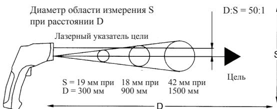
3. Для нахождения наиболее горячей точки направьте пиrometer на объект. Затем, удерживая курок, движением руки просканируйте поверхность вдоль и поперек, вверх и вниз, до тех пор, пока не найдете наиболее горячую точку.
