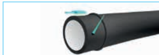
1. Очистка и смазка гладкого конца трубы
