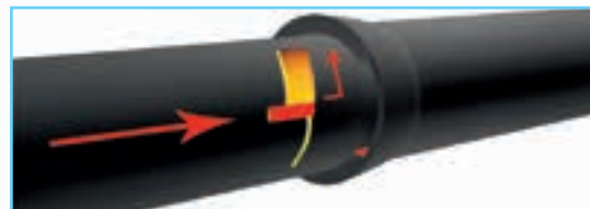
6. Установка левого стопора. Фиксация стопорной проволокой
