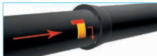
5. Стыковка труб и установка правого стопора
