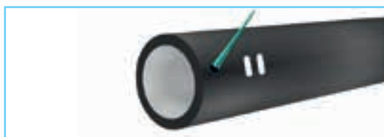
3. Смазка наружной поверхности гладкого конца трубы
