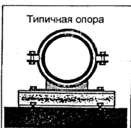
Рисунок 6.32 Трубопровод, закрепленный на сооружении.
