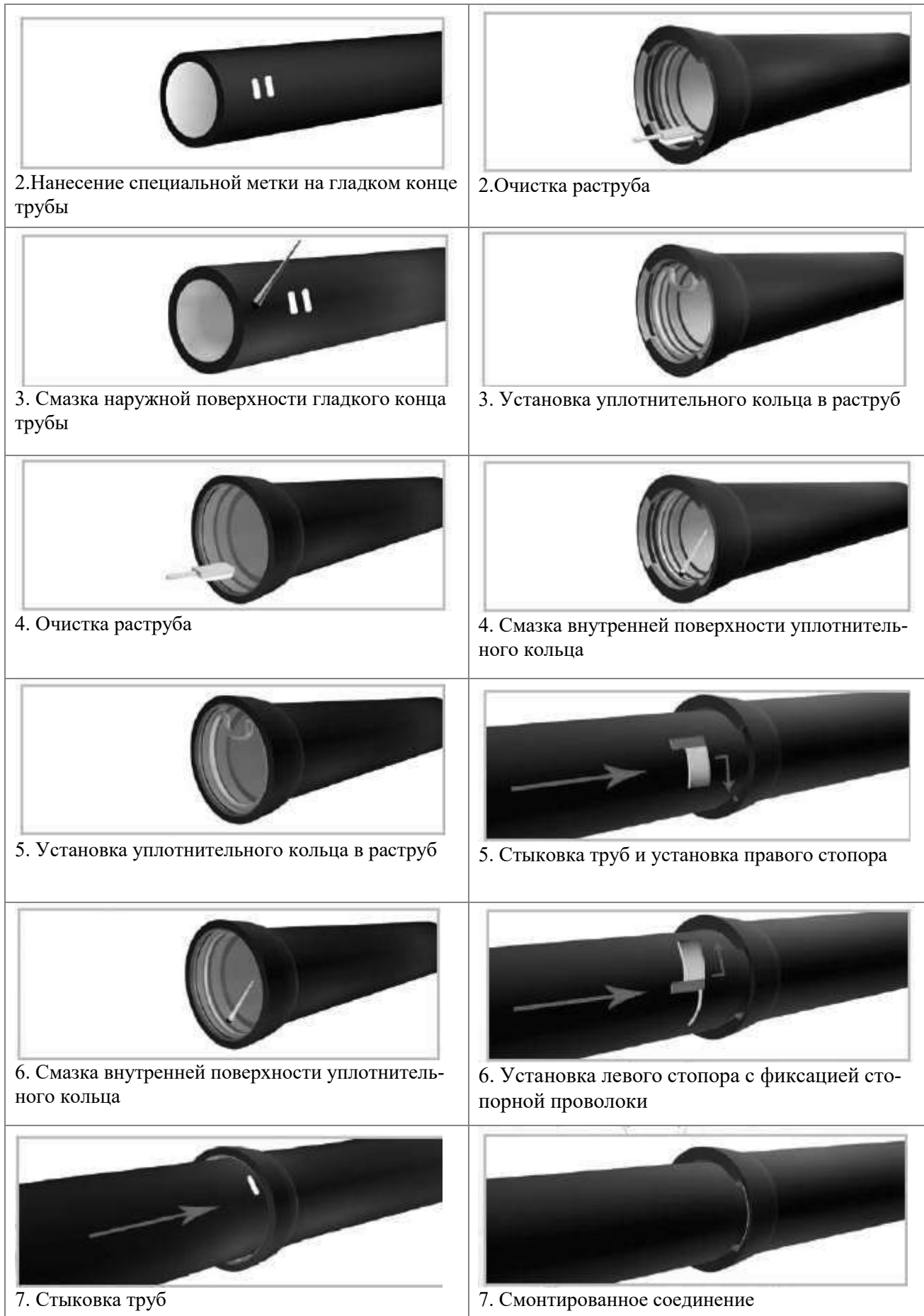
Рисунок 6.5 Монтаж труб с соединением TYTON и RJ.
