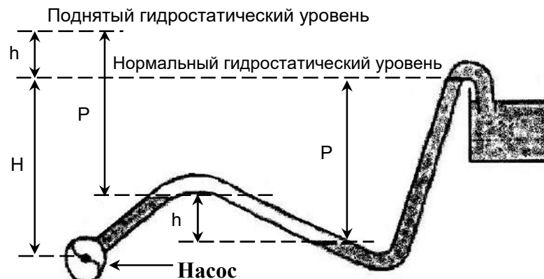
Рисунок 5.4 Условия в напорном трубопроводе.
