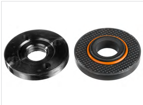
Специальные фланцы из разных материалов для исключения прикипания диска
