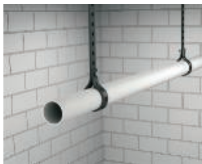
Подвес трубы с помощью монтажной ленты Трубы можно подвесить с помощью перфорированной монтажной ленты. Перфорированная монтажная лента состоит из металлической основы с пластиковой оболочкой.
