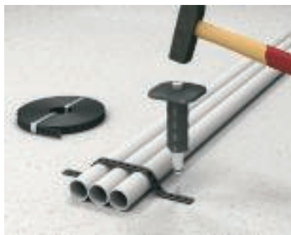
Крепление с помощью монтажной ленты Из перфорированной монтажной ленты можно самостоятельно изготовить скобы любой формы для крепления электромонтажных труб на полу с помощью дюбелей OBO 903/RB с насадкой для вбивания.
