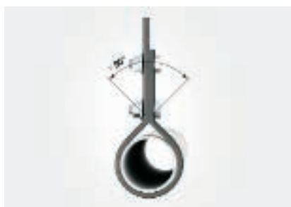
Вариант нагрузки 8: труба или подобное подвешивается на ленте Допустимая нагрузка А
