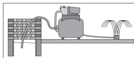
Станция предназначена для эксплуатации только с чистой пресной водой. В противном случае используйте устройства для фильтрации поступающей в насос воды (сетка, фильтр предварительной очистки).
