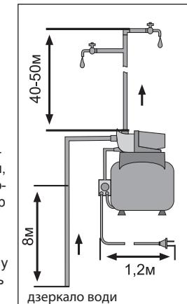
Встановіть станцію на рівну горизонтальну поверхню і закріпіть через отвори в опорах. Встановіть (якщо не встановлені) шланг високого тиску 5. Зберігте канали, що підводять і відводять, згідно. Діаметр під'єднуваних труб має бути 1".
