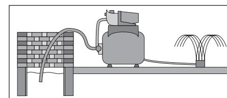
Станція призначена для експлуатації лише з чистою прісною водою. Інакше використовуйте пристрій для фільтрації води, що поступає в насос (сітка, фільтр попереднього очищення).
