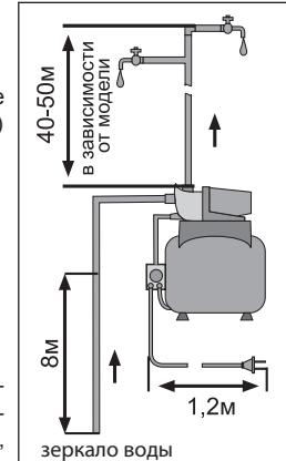
в опорах. Установите (если не установлен) шланг высокого давления 5. Соберите подводящий и отводящий каналы согласно рис. Диаметр подсоединяемых труб должен быть 1".
