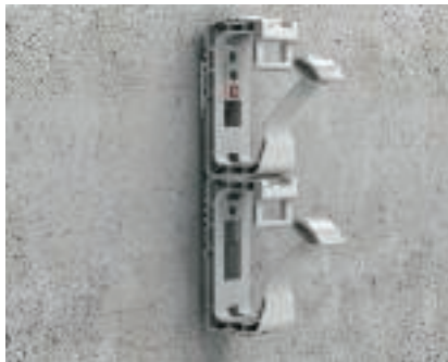
Присоединение в ряд друг под другом Несколько групповых креплений-захватов можно соединять рядами друг над другом. В зависимости от нагрузки и крепления не допускается соединять рядами друг над другом более двух групповых креплений-захватов ОВО. В зависимости от нагрузки достаточно, закрепить верхний GRIP.
