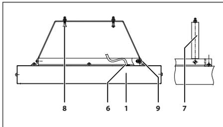
Закрепите кронштейны к профилям с помощью винтов 8.
