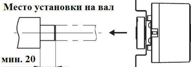
**Комплектные муфты для энкодеров с выступающим валом**
