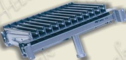
Источником тепла настенных котлов MAXIMUS является газовая горелка современной сборной конструкции изготовленная из нержавеющей стали. Ее главным преимуществом является очень низкий уровень шума и высокая эффективность.
