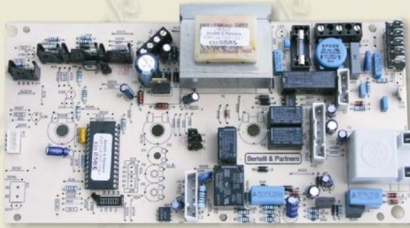
диапазоне (8-25 кет) плавно модулирует мощность котла. Тем обеспечено, что будет произведено столько тепла, сколько реально требуется. Одновременно экономится энергия и удлиняется срок службы котла. Все газовые котлы MAXIMUS работают без зажигающего пилота горелки. Горелка зажигается электрической искрой, вследствие чего достигается последующая экономия газа.
