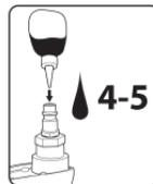
Для смазывания устройства применяйте масла для пневмоинструмента с вязкостью ISO-VG32 и автоматическую масленку воздушной магистрали, настроенную на подачу 2 капель в минуту. Если применение автоматической воздушной магистрали невозможно, то вводите 4-5 капель масла для пневматического инструмента в отверстие впускного патрубка перед
