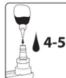
**HINWEIS: Vor der Inbetriebnahme des Werkzeug geben Sie 4-5 Tropfen Öl auf die Eingangsöffnung, bevor Sie den Schlauch anschließen.**
