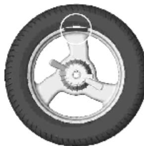
Рисунок 6.6 - Груз установлен в «12 часов»
