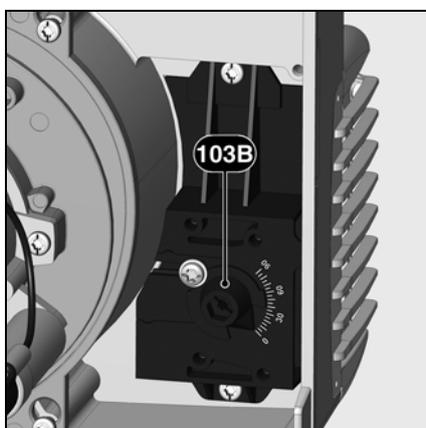
**Регулировка подачи воздуха посредством воздушной заслонки**
