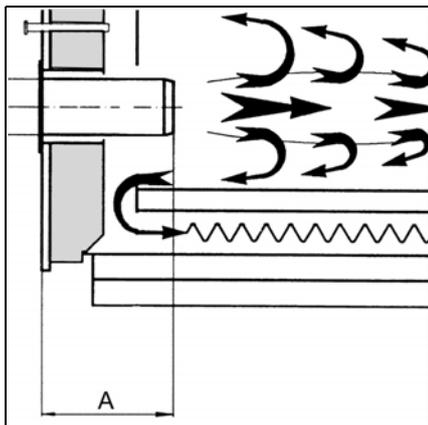
En caso de calderas de hogar ciego, se debe respetar la profundidad mínima de penetración **A** del tubo de llama teniendo en cuenta las indicaciones del fabricante de la caldera.
