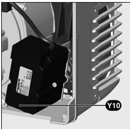
**Регулировка подачи воздуха посредством воздушной заслонки**
