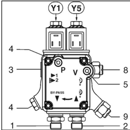
La bomba es de engranajes. La conexión de la misma debe hacerse con doble tubo a través de un filtro de desgasificación. Para la conexión entre la cisterna de gasóleo y el filtro de desgasificación, es preferible optar por la opción monotubo. La bomba incorpora un filtro de aspiración y dos reguladores de presión de gasóleo. Antes de la puesta en servicio, se debe instalar un manómetro para medir la presión (4) y el vacío (5).
