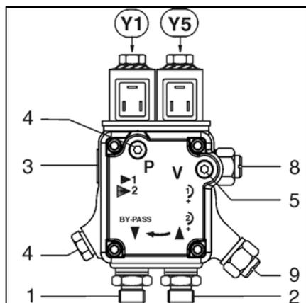
Насос шестерчатого типа, самовсасывающий. Он должен присоединяться к двум трубопроводам через фильтр для удаления газов. Для соединения между топливной цистерной и фильтром для удаления газов предпочтителен однотрубный вариант. В насосе имеется входной фильтр и два регулятора давления топлива. Перед пуском в работу установите манометр для измерения давления **4** и разрежения **5**.
