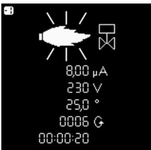
С помощью клавиш **▼** и **▲** можно вызвать информацию о 5 последних появившихся неисправностях (номер неисправности отображается в левом верхнем углу дисплея). После информации о 5 последних неисправностях появляется номер телефона службы послепродажного обслуживания, а также номер договора на техническое обслуживание (ни одно из значений не вводится на заводе).
