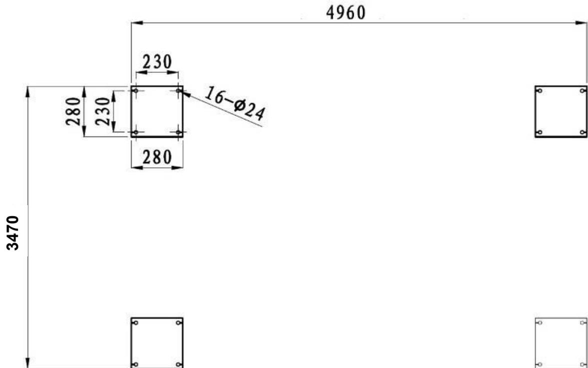
Рисунок 3а. Установочные размеры подъемника
