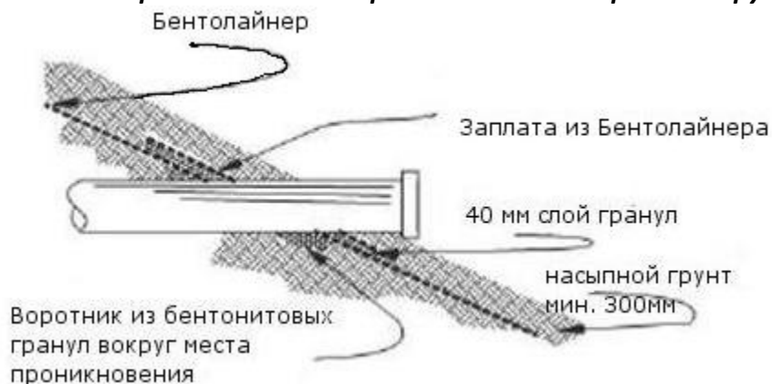
Рисунок 4а. Поперечное сечение горизонтально внедренной трубы.
