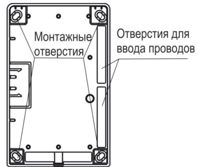
4. Провести провода от источника питания, шлейфа сигнализации, интерфейса RS-485, линии ТМ через отверстие для ввода проводов.
