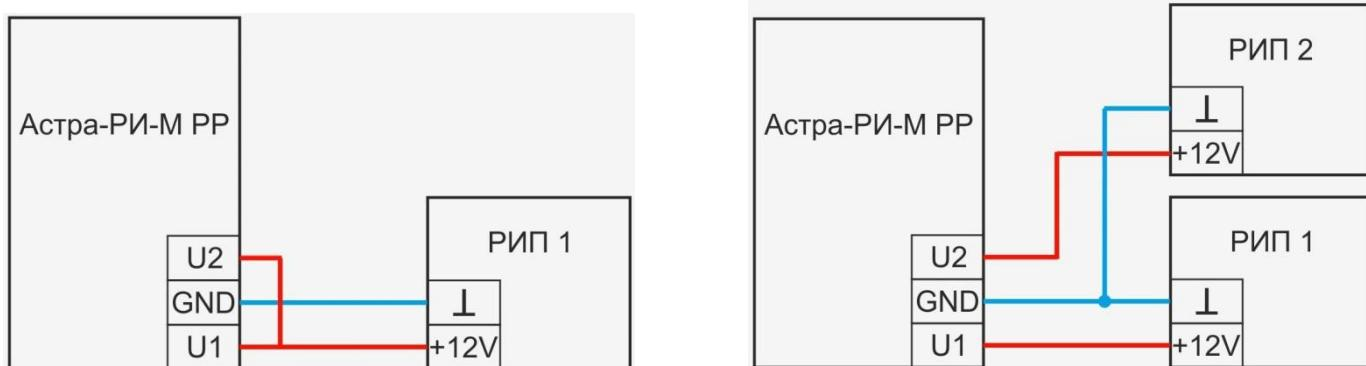
Рисунок.6. Схема подключения питания прибора (слева – с одним РИП, справа – с двумя РИП)
