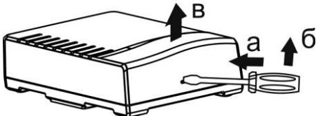
Рисунок 3. Открытие корпуса прибора
