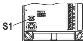
5. Кратковременно **на 1 с замкнуть** перемычку **F1** на извещателе, затем нажать **на 1 с** и отпустить **кнопку вскрытия** на извещателе (индикатор извещателя замигает **белым** цветом с частотой 8 раз/с).
