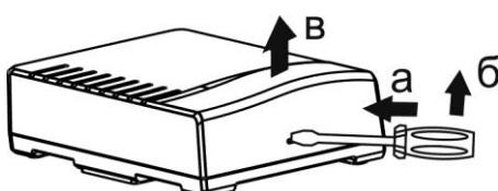
2. Снять печатную плату, отвернув винт в основании:
