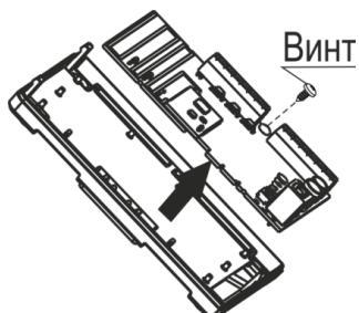
3. На выбранной поверхности сделать разметку под монтажные отверстия, используя основание PP в качестве трафарета.
