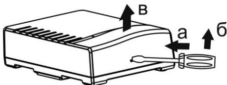
Рисунок 5. Открытие корпуса прибора
