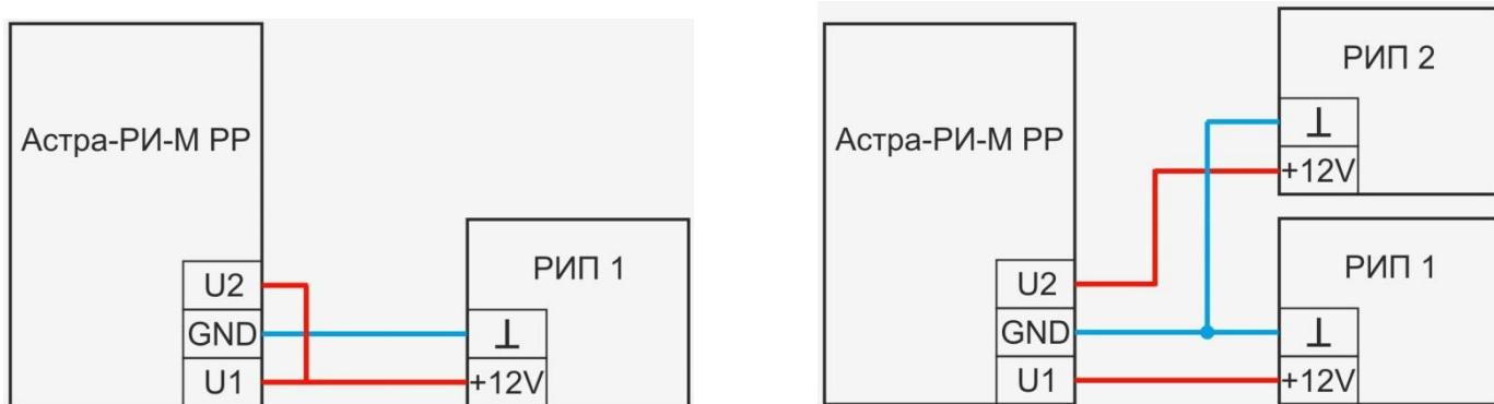
Рисунок 4. Схема подключения питания прибора (слева – с одним РИП, справа – с двумя РИП)
