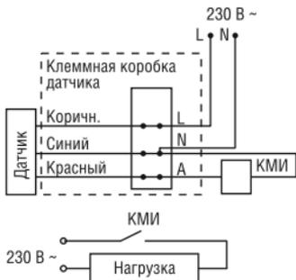
Рисунок 21 – Схема подключения датчика с контактором КМИ
