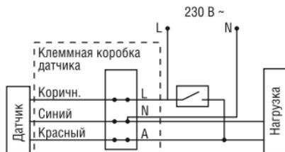
Рисунок 20 – Схема режима постоянного включения нагрузки
