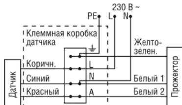
Рисунок 18 – Схема подключения датчиков типов ДД-017, ДД-019
