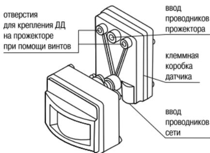
Рисунок 16. Конструкция датчика движения ДД017
