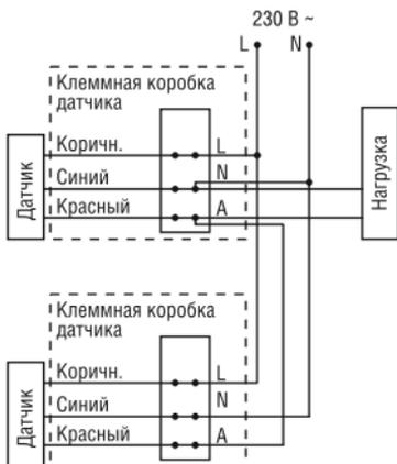
Рисунок 19 – Схема параллельного подключения датчиков
