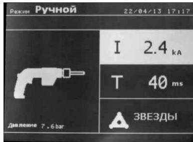
В ручном режиме макс. сила тока составляет 9 кА в течение промежутка времени  $\leq 600$  мс. Таким образом, настройки на экране будут заблокированы на этих максимальных величинах. Настройте генератор, задав толщину свариваемого листа металла с помощью кнопок «+» или «-». Параметры тока и времени возможно изменить в ручном режиме.
