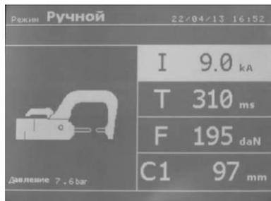
Настройки, предлагаемые по умолчанию в режиме Ручной, соответствуют преобразованию настроек, совершенных в нормальном режиме (преобразование толщины и типа металла в ток, в продолжительность и усилие на клещах).
