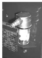
Пневматический фильтр, подключение к пневматической системе
