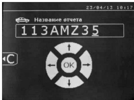
Запись отчета позволяет сохранить данные по серии сварных точек, совершенных с помощью клещей, с тем, чтобы записать их на карту памяти и потом вывести их на компьютер. Специальная компьютерная программа позволяет считывать информацию с SD карты и распечатывать отчеты. Эта программа находится на SD карте вместе с инструкцией по эксплуатации.
