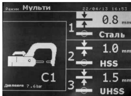
Этот режим позволяет совершить точную настройку толщины и типа каждого из 2 или 3 листов металла:
