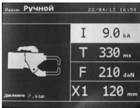
Настройки, предлагаемые по умолчанию в ручном режиме, соответствуют преобразованию настроек в нормальном режиме (преобразование толщины и типа металла в ток, в продолжительность и в силу сжатия). Величину параметров можно изменить с помощью кнопок «+» и «-».
