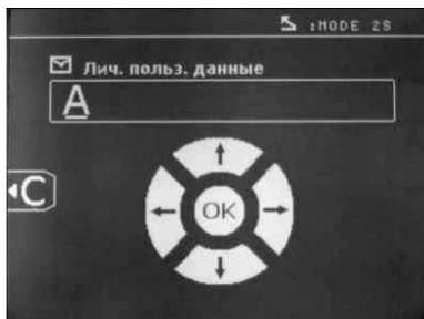
Кнопки ← и → позволяют перемещать стрелку по полю. Кнопки ↓ и ↑ позволяют менять буквы или цифры. Короткое нажатие на кнопку Esc позволяет стереть поле. Кнопка «Режим» позволяет прокрутку полей для их изменения или считывания.
