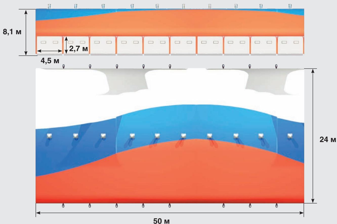
Ангары DoorHan представляют собой тенто-мобильные укрытия, предназначенные для стоянки, хранения и обслуживания самолетов, вертолетов и спецтехники. Укрытия такого типа легко монтируются, удобны в эксплуатации и при необходимости могут быть оперативно демонтированы и перевезены на новое место дислокации. При транспортировке не занимают много места.
