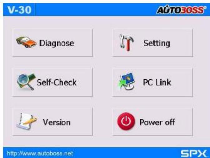
После запуска сканера, появится интерфейс как на рисунке слева. Он включает в себя [Diagnose], [Setting], [Self-Check], [PCLink], [Version] и [Power off].
