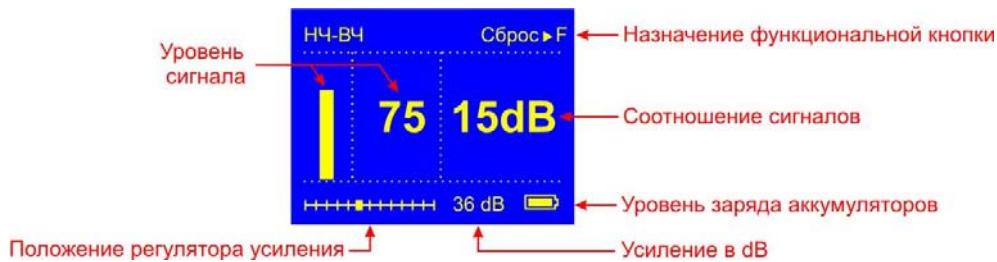
Обнулите показания кнопкой **F**. При движении вдоль трассы могут «небегать» отрицательные показания. Их следует обнулять.
