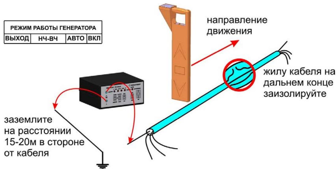
Подключите генератор к поврежденной паре. При этом рекомендуется работать на максимально коротком участке кабеля, чтобы уменьшить паразитный сигнал через емкость кабеля. Желательно, чтобы дефект был ближе к дальнему от генератора концу кабеля.
