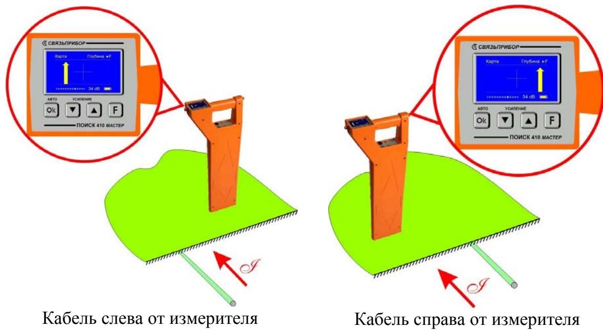
По направлению стрелки можно отличить «свой» кабель от «чужого», поскольку направления тока в «своем» кабеле противоположно возвратным токам, протекающим по чужим коммуникациям:
