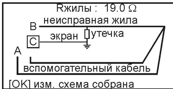
Нажмите кнопку [OK]. Прибор покажет расстояние до повреждения неисправного кабеля в процентах длины для неизвестного кабеля или в метрах, если длина введена. Если неисправная жила диаметром больше 1,2 мм, то измерительный провод В может внести дополнительную погрешность. Чтобы проверить это, подключите провод С к началу неисправной жилы, куда подключен В.
