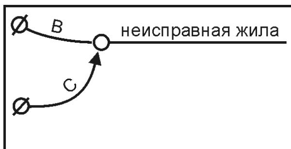
Повторите последнее измерение, нажав кнопку [OK]. Если результат отличен от 0, то его надо вычесть из полученного расстояния до дефекта.
