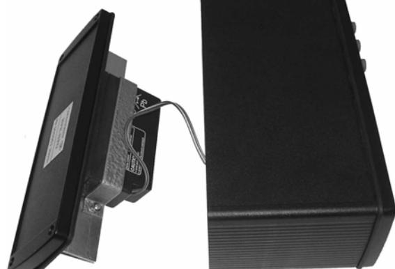
Для длительной и надежной работы прибора полностью заряжайте аккумулятор (индикатор «ЗАРЯД» на ЗПУ не должен светиться). Перед выходом на линию проверяйте уровень напряжения на аккумуляторе.
