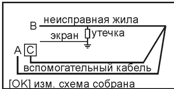
Собрав схему, нажмите [OK]. Сначала прибор измерит сопротивление плохой жилы В и приведет ее к масштабу 100%, после чего подаст сигнал и покажет, что провод С следует подключить к экрану кабеля (земле).
