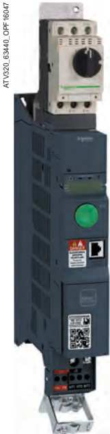
Прямое крепление автоматического выключателя GV2 к преобразователю частоты ATV 320: GV2L08 + (VW3A9921 + GV2AF4) (5) + ATV320U07N4B
