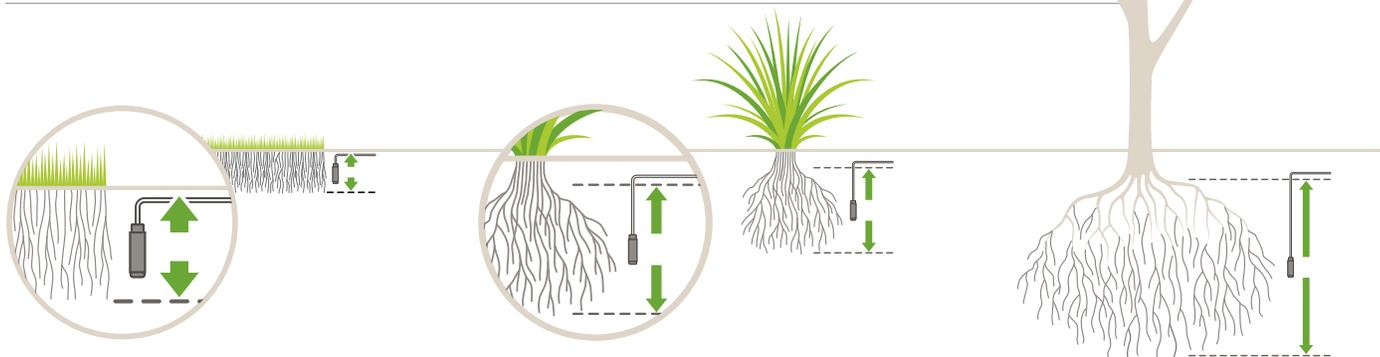
При использовании в дерне датчик следует располагать в корневой зоне, на глубине приблизительно 15 см (это значение может быть изменено в соответствии с состоянием дерна).
