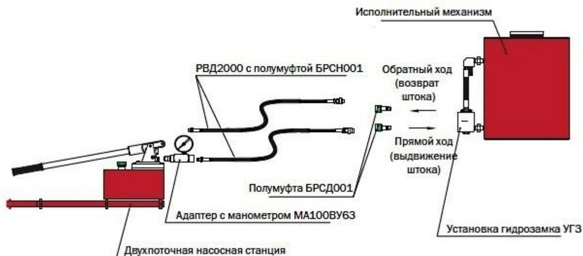
Рисунок 3 Система из одного домкрата двустороннего действия, подключенного к двухпоточному ручному насосу
