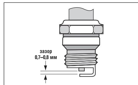
При замене используйте соответствующие свечи зажигания – TORCH F6RTC.
