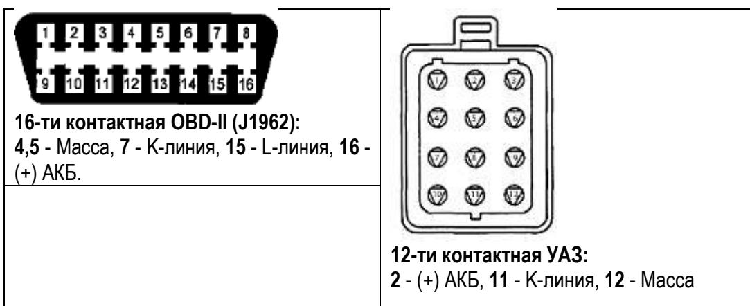
Для 16-ти контактной колодки используйте [переходник OBD-16](#). Для 12-ти контактной - [ГАЗ-12](#).
