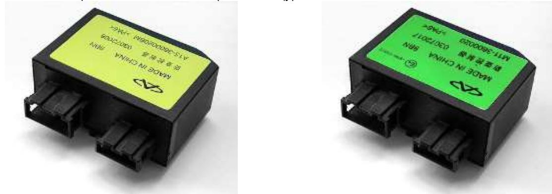
**A15-3600020BM** – не имеет внешнего EEPROM, тип транспондеров: PCF7935AS. Допускает привязку чистых транспондеров и повторную привязку уже использованных.
