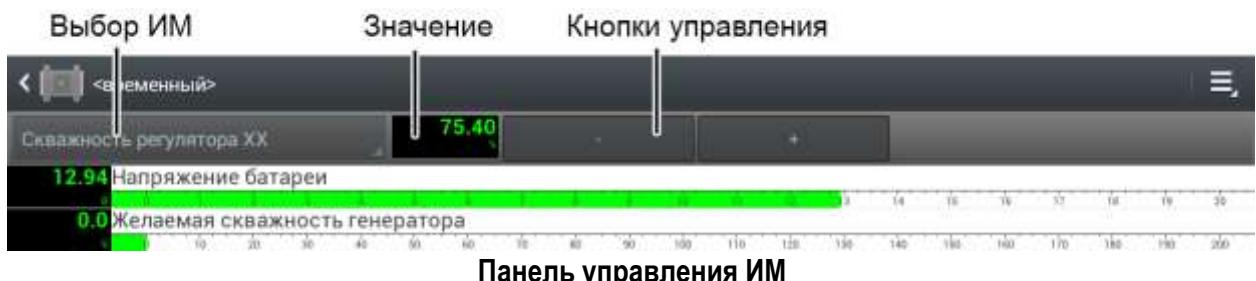
Выберите исполнительный механизм из раскрывающегося списка на панели управления. В правой части панели отображаются кнопки управления. При помощи кнопок на панели механизм переводится в одно из возможных положений (ВКЛ / ВЫКЛ, ОТКРЫТЬ / ЗАКРЫТЬ и др.) или его значение плавно изменяется (кнопки “-” / “+”).
