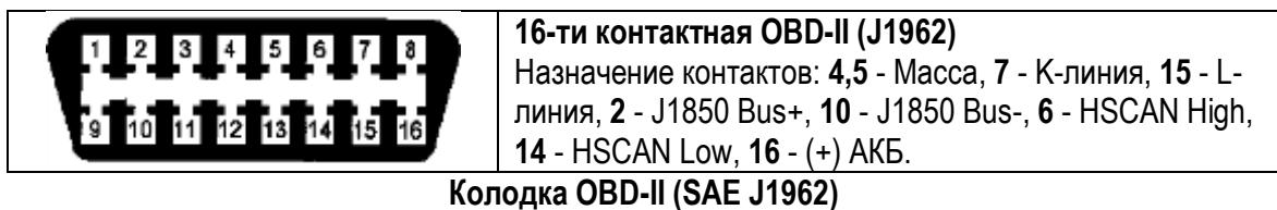
**ПРИМЕЧАНИЕ.** В диагностической колодке могут присутствовать только контакты, используемые для выбранного производителем автомобиля протокола. Например, для протокола CAN используются только контакты 4, 5, 6, 14, 16.
