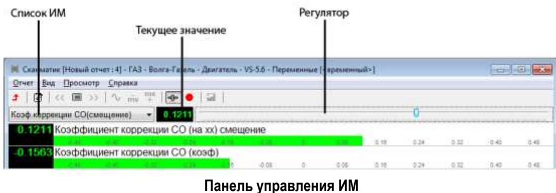
Выберите исполнительный механизм из раскрывающегося списка на панели управления. В зависимости от типа исполнительного механизма в правой части панели отобразятся кнопки или линейный регулятор. При помощи кнопок на панели управления исполнительный механизм переводится в одно из возможных положений (ВКЛ/ВЫКЛ, ОТКРЫТЬ/ЗАКРЫТЬ и др.). Линейный регулятор служит для плавного управления такими исполнительными механизмами как регулятор холостого хода и др.
