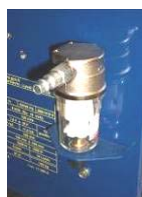
Пневматический фильтр, подключение к пневматической системе
