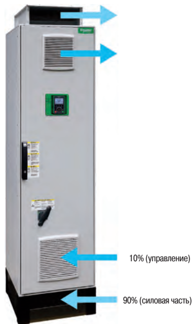
Система охлаждения с разделением потоков воздуха
