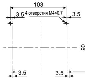
※ Момент затяжки монтажных болтов для реле со съёмным радиатором: 1,35 Н·м
