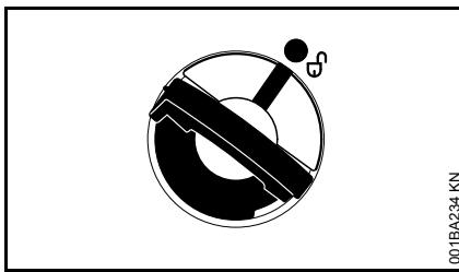
Маркировки на крышке бака и топливном баке должны друг с другом совпадать
