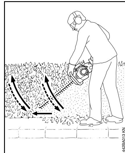
Мотоножницы вести дугообразно снизу вверх – опустить вниз и продолжать двигаться дальше – мотоножницы снова вести дугообразно вверх.
