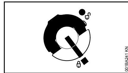
Крышка бака зафиксирована
