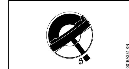
Тогда будут совпадать между собой маркировки на крышке бака и топливном баке
