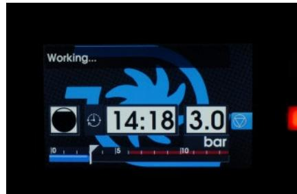
4. Во время процедуры необходимо повышать обороты двигателя от 1000 до 2500 об/мин так часто как это возможно, для достижения максимального эффекта очистки топливной системы.
