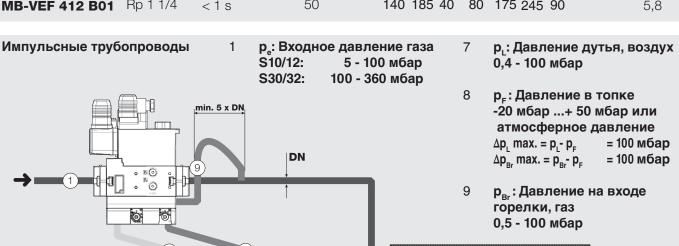
Импульсные трубопроводы 7, 8, 9 должны иметь внутренний номинальный диаметр (DN) ≥ 4 (Ø 4 мм), номинальное давление PN 1 и должны быть изготовлены из стали. Импульсные трубопроводы, изготовленные из других материалов могут быть допущены к эксплуатации лишь после испытания модели вместе с горелкой.
