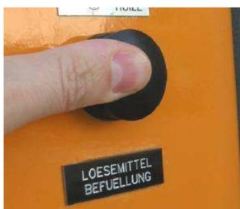
Полуавтоматическая загрузка бака дистиллятора с контролем уровня посредством простого нажатия кнопки. Для загрузки используется пневматический насос или вакуумное разряжение (при наличии вакуумной системы).
