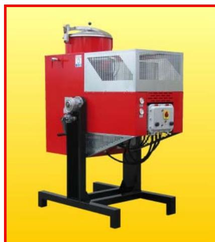
Выпаривание загрязненного растворителя происходит внутри бака из нержавеющей стали AISI 304, помещенного в оболочку, наполненную диатермическим маслом, которое нагревается нагревательным резистором. Образовавшиеся пары проходят через конденсатор, который охлаждается воздухом или водой. Полученный таким образом растворитель собирается в сосуде и готов к дальнейшему использованию.
