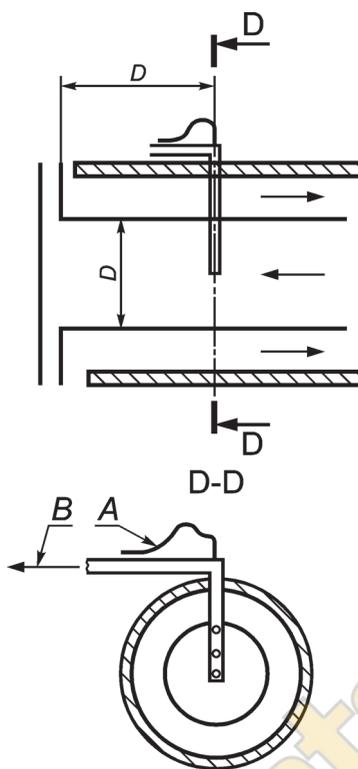
A — к устройству считывания температуры;
