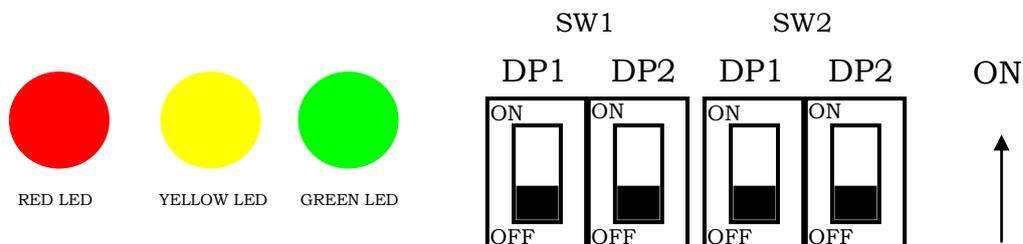
Набор переключателей SW1 (непосредственно рядом с зеленым светодиодом) отвечает за выбор профиля заряда. Набор переключателей SW2 отвечает за выбор зарядного тока (DIP1) и напряжения батарей (DIP2).
