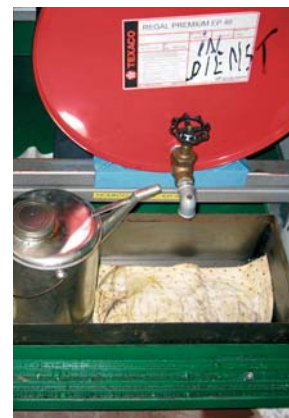
Салфетки OP разложены под резервуарами и масленками для сбора возможных маслоротечек.
