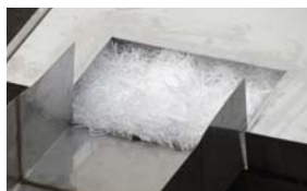
Фильтрация сточных вод перед сливом в основной резервуар.
