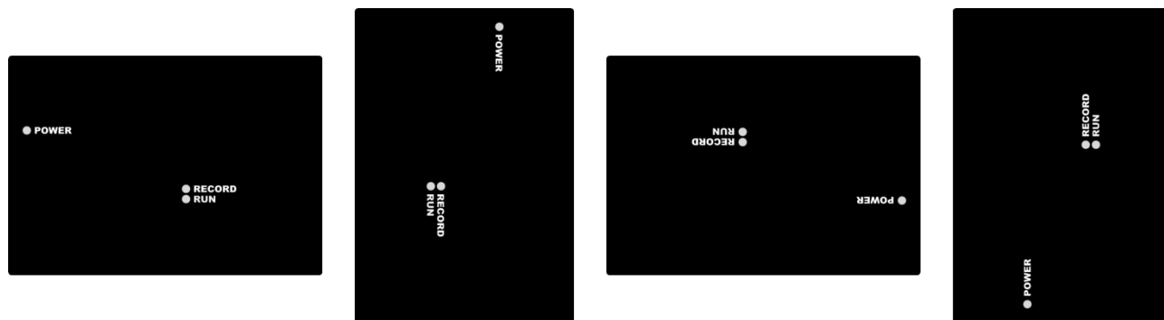
Рис. 29 Варианты размещения Sprut SR-1000 на вертикальной поверхности
