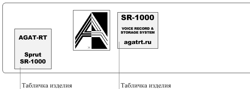
Рис. 5 Передняя боковая панель Sprut SR-1000 с защищенной памятью, таблички изделия.
