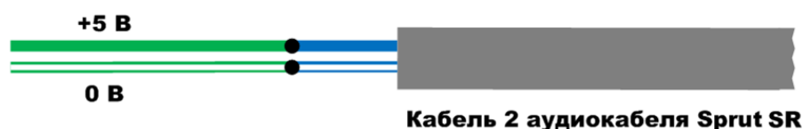
Рис. 58 Подключение проводов прямым соединением
