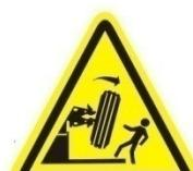
После разбортировки шины колесо может упасть. Убедитесь в отсутствии посторонних людей в рабочей зоне.
