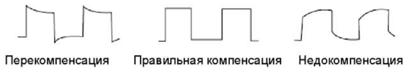
Рисунок 8. Калибровка компенсации щупов.
