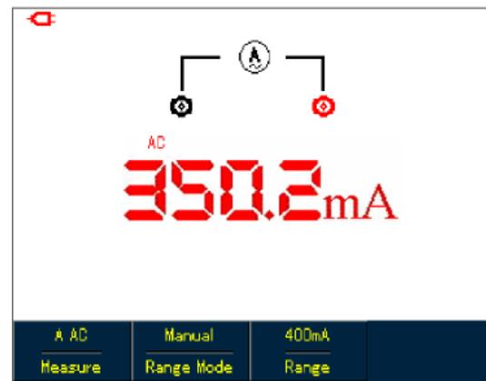
Рисунок 5-19. Измерение переменного тока от 40 до 400 мА (UTD1000DL)
