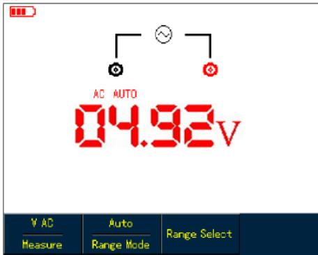
Рисунок 5-6. Измерение переменного напряжения
