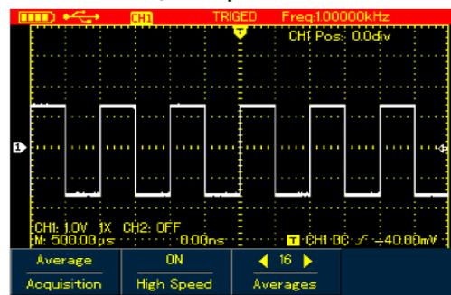
Рисунок 4-19. Сглаживание в режиме усреднения по 16 наборам данных
