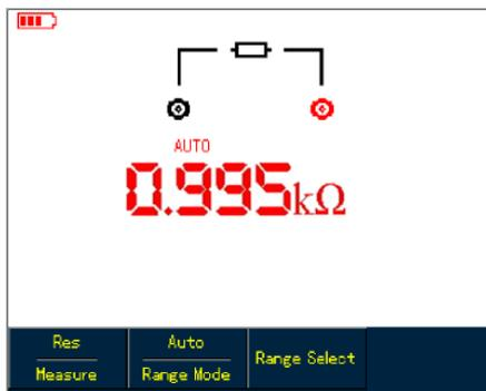
Рисунок 5-1. Измерение сопротивления
