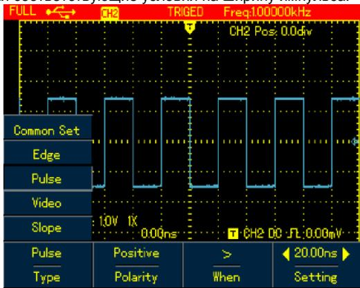
Рисунок 6-10. Запуск по ширине импульса
