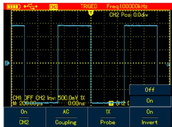
Рисунок 4-23(б). Обращенная осциллограмма (модель UTD1000DL)
