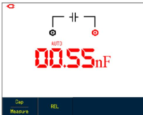
Рисунок 5-22. Измерение емкости в режиме относительных измерений
