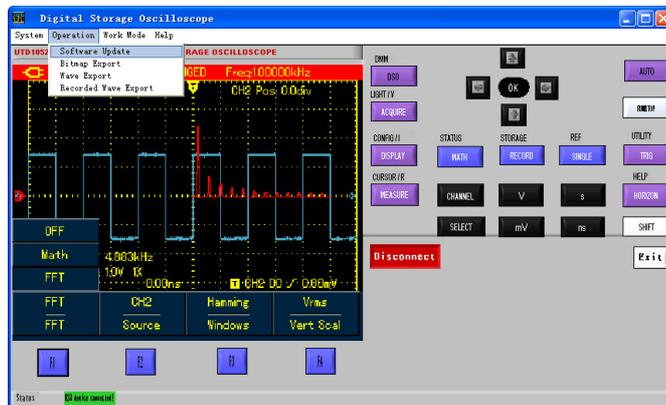
Рисунок 8-2. Обновление прошивки осциллографа
