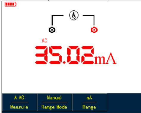
Рисунок 5-11. Измерение переменного тока до 400 мА (UTD1000CL)
