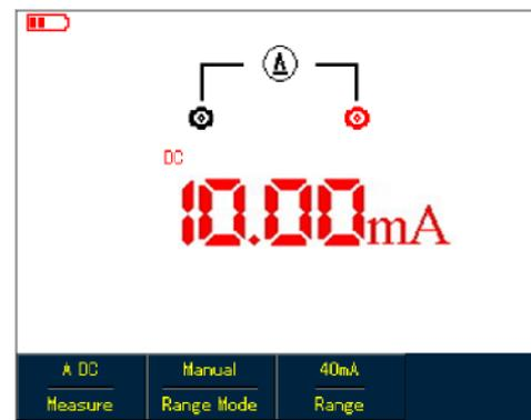
Рисунок 5-14. Измерение постоянного тока до 40 мА (UTD1000DL)
