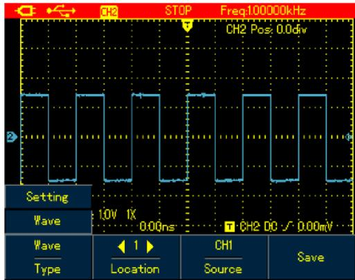
Рисунок 6-26(б). Меню сохранения осциллограмм в модели UTD1000DL
