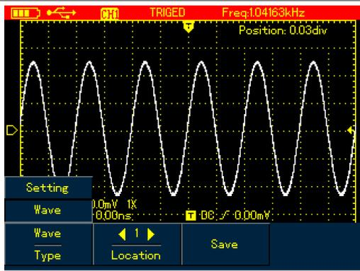
Рисунок 6-26(а). Меню сохранения осциллограмм в модели UTD1000CL
