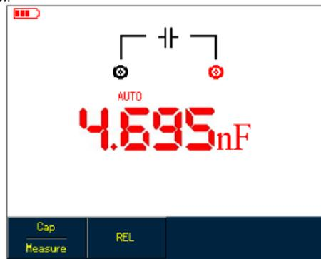
Рисунок 5-4. Измерение емкости
