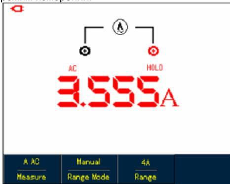
Рисунок 5-21. Фиксация показания дисплея
