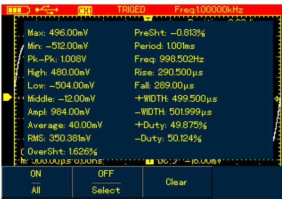
Рисунок 4-17(б). Измерение полного набора параметров в осциллографе UTD1000DL
