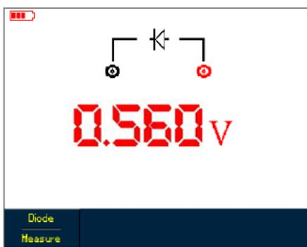
Рисунок 5-2. Проверка диодов
