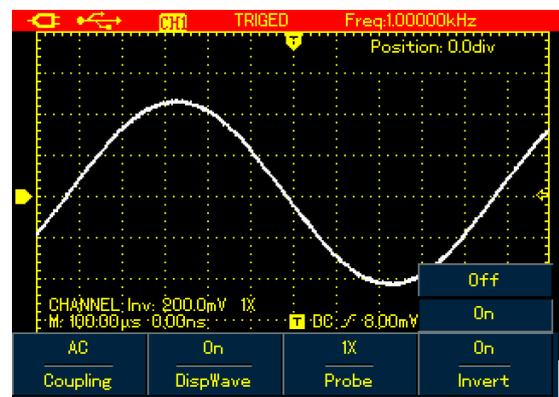
Рисунок 4-23(а). Обращенная осциллограмма (модель UTD1000CL)
