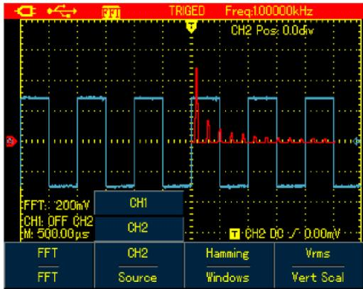
Рисунок 6-30. Операция быстрого преобразования Фурье при работе с моделью UTD1000CL
