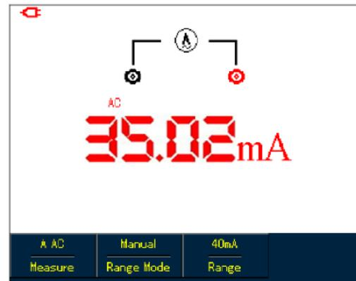
Рисунок 5-18. Измерение переменного тока до 40 мА (UTD1000DL)
