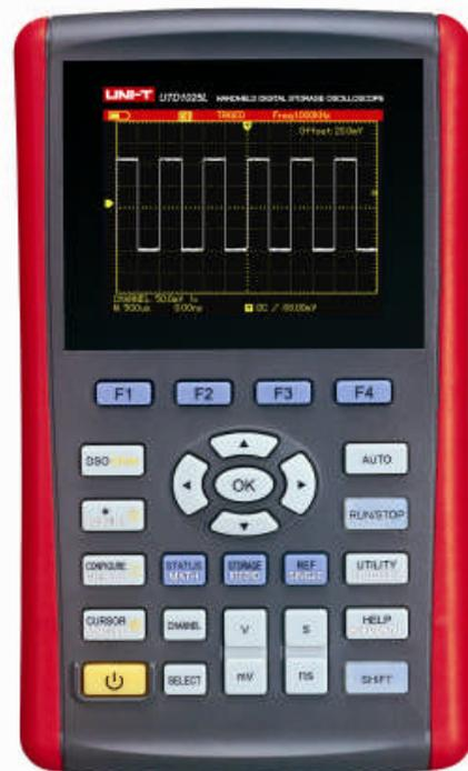
Рисунок 3-3. Панель управления осциллографов серии UT1000L
