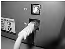
5-сурет. Дисплейдің DORS 800 есептегішіне жалғануы.
