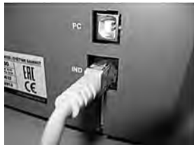
Рис. 5 Подключение дисплея к счетчику DORS 800.
