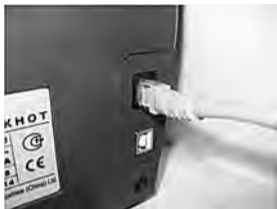
4-сурет. Дисплейдің DORS 700/750 есептегіштеріне жалғануы.
