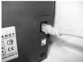
Рис. 4 Подключение дисплея к счетчикам DORS 700/750.
