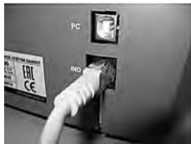
Мал. 5 Підключення дисплея до лічильника DORS 800.
