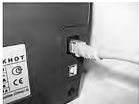
Мал. 4 Підключення дисплея до лічильників DORS 700/750.
